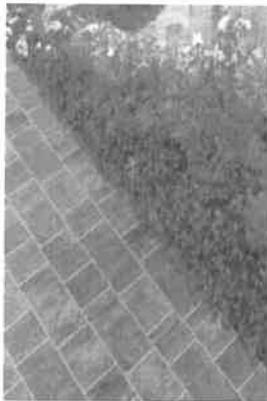
**Zapfendorfer-Via-Plaza-Pflaster**, 8 cm Stärke, Kanten mit Microfase, 3 Formate lagenweise gemischt ❷, mit Verschiebesicherung, Ökopflaster – keine Flächenversiegelung, Prüfzeugnis mit Nachweis für Versickerungsfähigkeit liegt vor!
